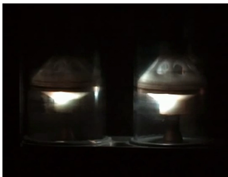
Load break CO 27kV/630A 15%C4/85%CO2 mix
